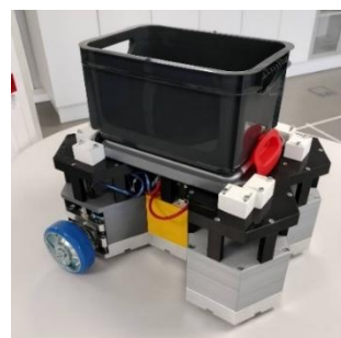
Robot mobil modular cu doua roti convenționale si tracțiune diferențială
