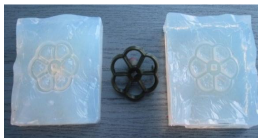
Matriță fabricată din cauciuc siliconic
