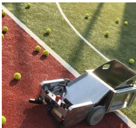
Fig. 4 Robot autonom de colectare a mingilor de tenis
