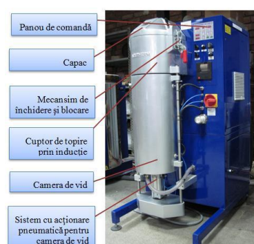
Echipament de turnare sub vid Indutherm - VC 1000 D
