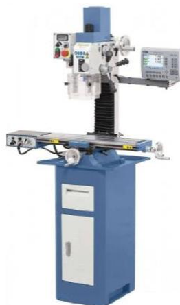
Mașină de găurit și frezat KF 25 Pro
