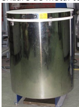
Cuptor pentru uscarea formelor ceramice TC 507
