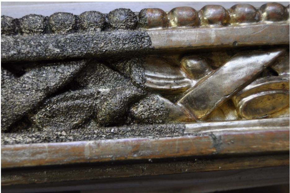
Foto. 6 a și b Etape de decapare la nivelul ramei
