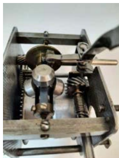
Fig. 19. Montarea generală a motorului. În timpul restaurării.
