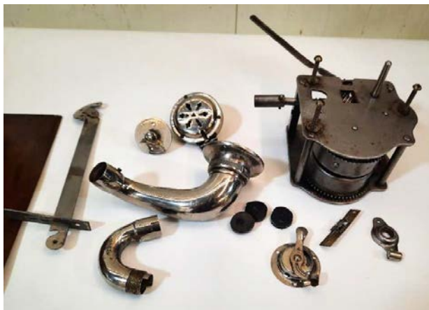
Fig. 22. Tratament de curățire și de conservare a suprafețelor nichelate. După restaurare.
