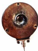
Fig. 20. Membrana fisurată și deformată. În timpul restaurării.
