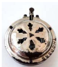
Fig. 20. Membrana fisurată și deformată. În timpul restaurării.
