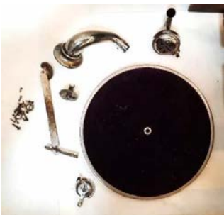
Fig. 14. Componente metalice ale patefonului. În timpul restaurării.
