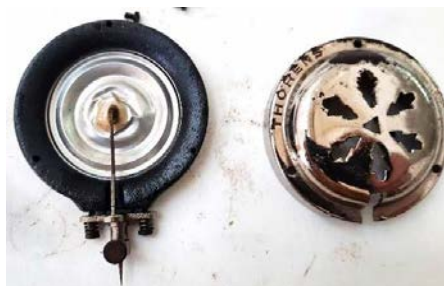
Fig. 20. Membrana fisurată și deformată. În timpul restaurării.
