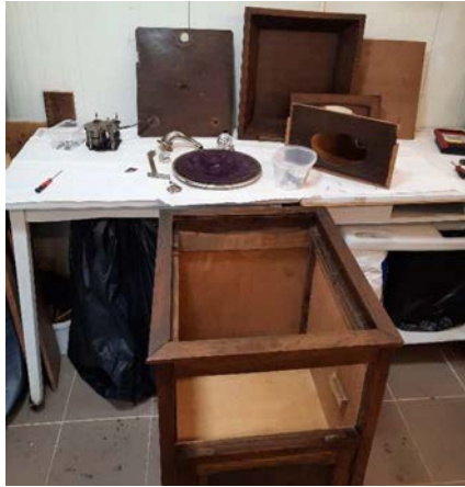
Fig. 13. Demontarea patefonului. În timpul restaurării.
