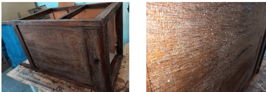
Fig. 23. Decaparea straturilor degradate de shellac. În timpul restaurării.
